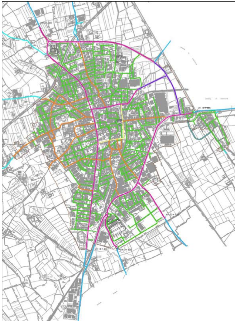
Figura 2 – Classificazione delle infrastrutture stradali esistenti (PGTU)
